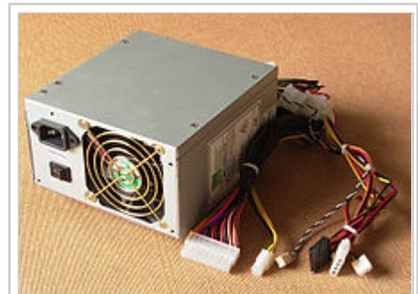
PC-Netzteil für ATX-Systeme
