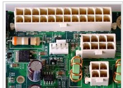
24pin Hauptstrom, 8pin CPU, 4 Pin CPU - Motherboard Seite
