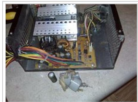
Explodierter Kondensator im PC-Netzteil
