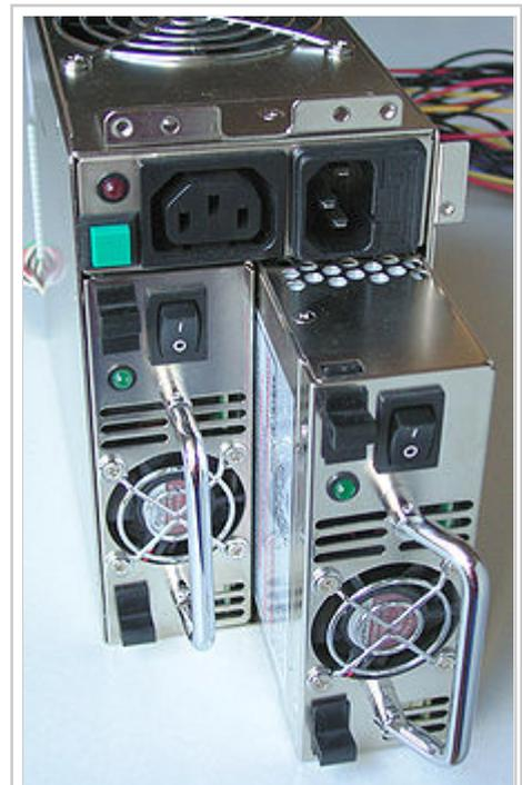
Redundantes PC-Netzteil für ein 19"-Gehäuse
