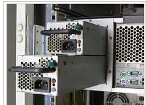
Redundantes PC-Netzteil mit separaten Eingängen
