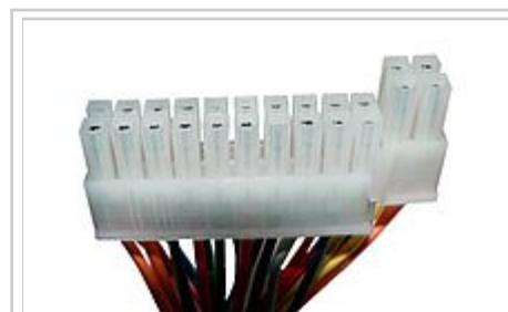
ATX 20 Pin Hauptplattenanschluss mit 4-Pin-Erweiterung
