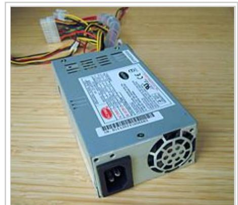
PC Netzteil für 1HE-Gehäuse mit 40mm-Lüfter, elektrisch ATX-kompatibel
