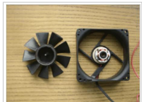
Geöffneter 80 mm Lüfter mit Gleitlager
