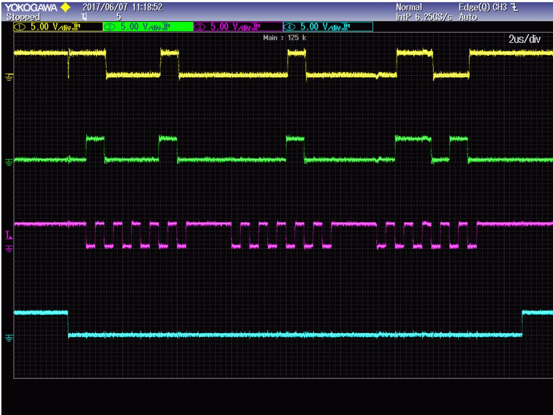
**Bild: 51** Senden von 3\*6=18 Bit Daten bei CPAH = 1 und CPOL = 1
