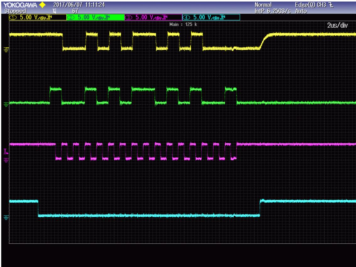
**Bild: 40** Senden von 16 Bit Daten bei CPAH = 0 und CPOL = 1
