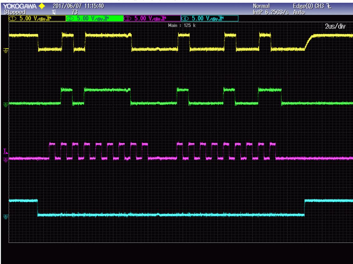
**Bild: 46** Senden von  $2 \cdot 9 = 18$  Bit Daten bei CPAH = 1 und CPOL = 0
