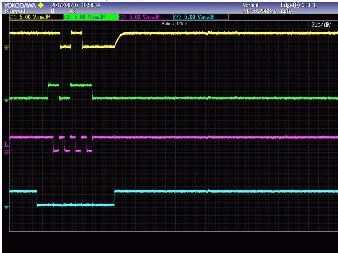
**Bild: 28** Senden von 4 Bit Daten bei CPAH = 0 und CPOL = 1
