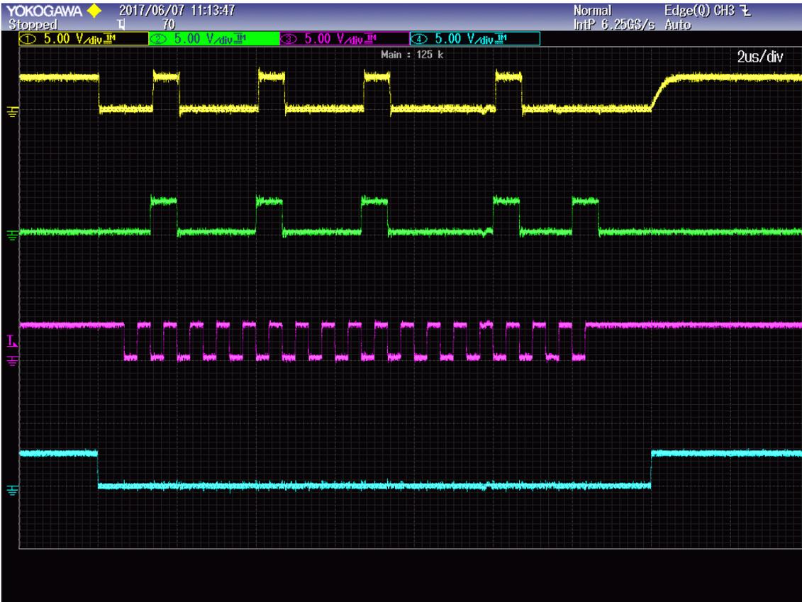
**Bild: 43** Senden von 18 Bit Daten bei CPAH = 1 und CPOL = 1
