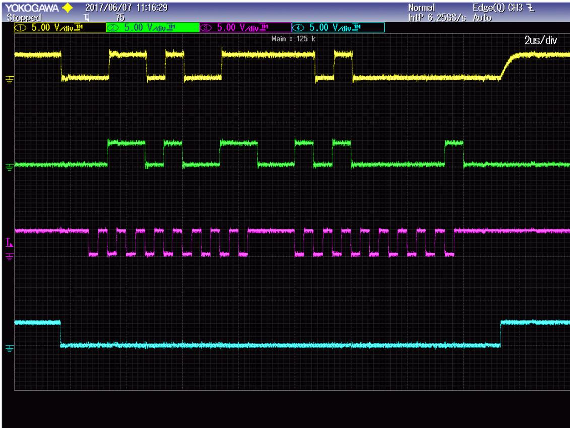
**Bild: 47** Senden von 2\*9=18 Bit Daten bei CPAH = 1 und CPOL = 1
