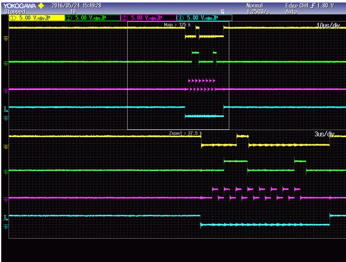
Bild: 07 Senden von „a“ bei CPAH = 1 und CPOL = 0
