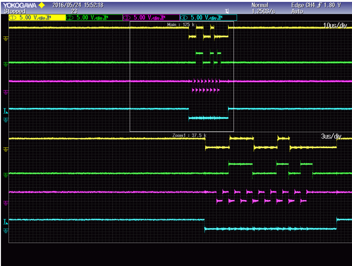
Bild: 17 Senden von „e“ bei CPAH = 1 und CPOL = 1
