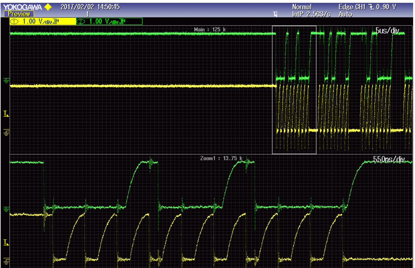
Bild 2: Senden der Adresse 0x12 mit dem WR-Flag und ACK. Die Übertragung beginnt mit einem Start.
