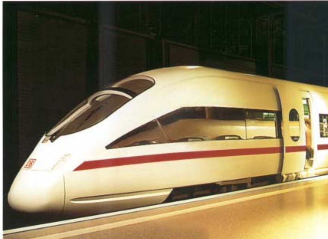
ICE 3-Triebzug DB (2000-2004) - ca. 63 Züge 8-teilig, 350 t, 8 MW, 330 km/h, F_{za} = 200 kN, auch als Viersystemtriebzug
