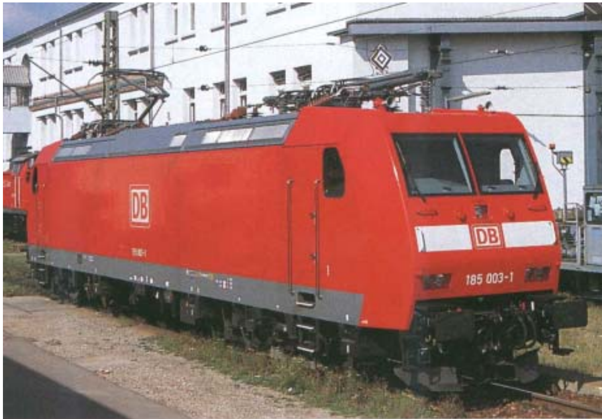
BR 185 (ab 2000) – Güterzug-Ellok (ADtranz, Bombardier Transportation) 4,2 MW, 140 km/h, 84 t,
