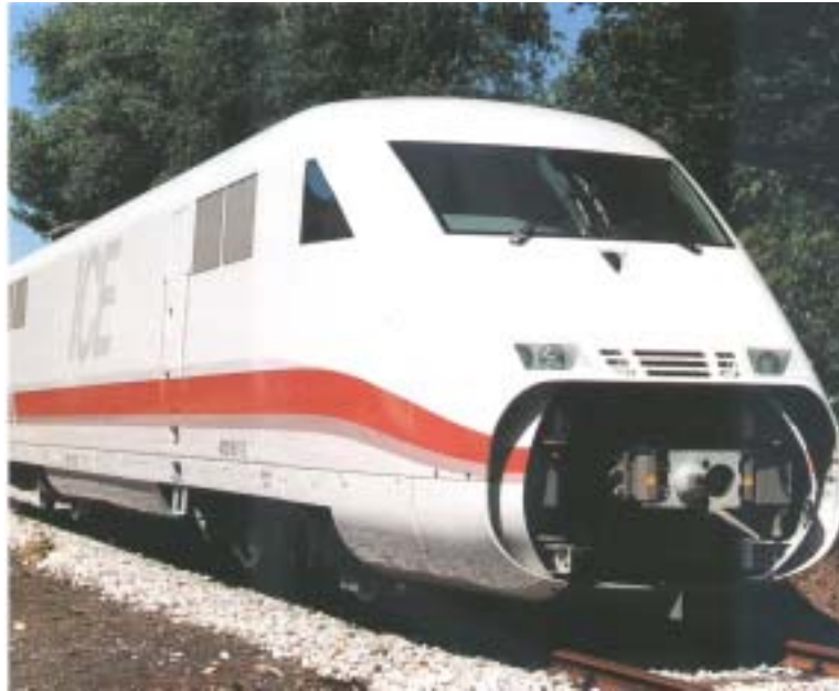
ICE 2 (BR 402) GTO-Ausführung des ICE (Siemens – AEG – 1995 -1997) Frontansicht mit geöffneter Scharfenberg-Kupplung Triebkopf: 78 t, 280 km/h, 200 kN, 4,8 MW
