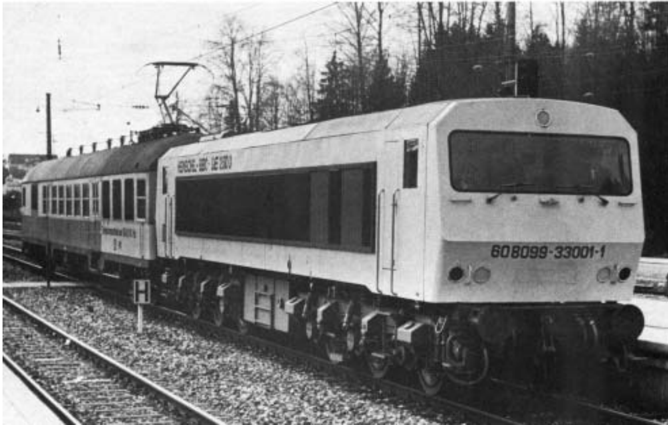
Versuchszug zur Erprobung der Drehstrom-Traktion (DE 2500 Henschel + BBC (1970))
