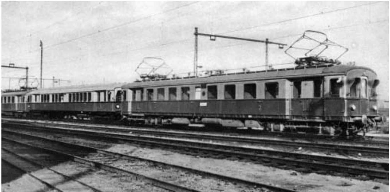
Wechselstrom-Triebwagenzug (15 kV, 16 2/3 Hz) für die Strecke Halle - Leipzig (1928)
