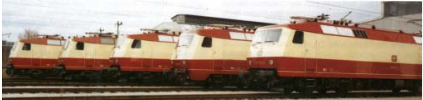
BR 120 001 - 005 Vorserie in Thyristortechnik - Erprobung 1979 -1983 (4 Mio. km)
