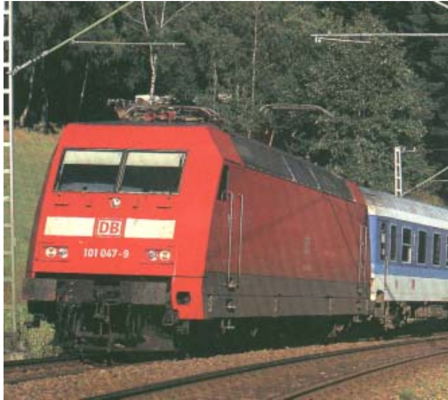
BR 101 DB Schnellzuglok (1997) ADtranz 6,4 MW, 220 km/h, 86,9 t
