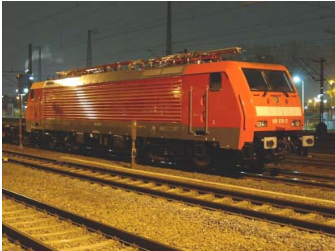
BR 189 DB Siemens (2003) – Viersystem-Cargo-IGBT-Lok, 140 km/h (100 Einheiten für die DB bestellt) Quelle: Siemens
