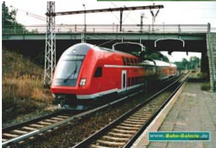
Dreiteiliger Doppelstock-Triebzug BR 445 für die DB (Siemens+Adtranz) 2003 Daten: 180 t, 2.7 MW, 140 km/h, F_{za} = 200 \text{ kN} – Testfahrt (Quelle: Bahn-Galerie.de)
