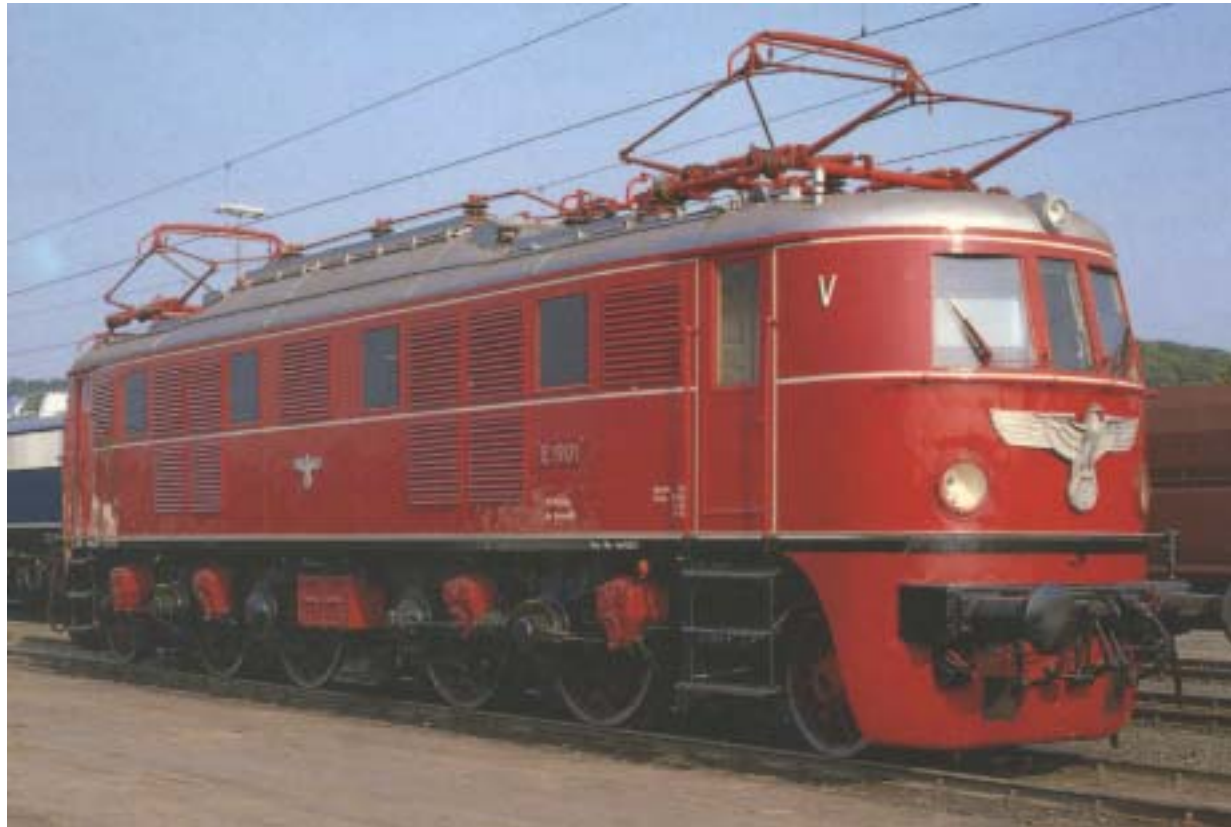
16 2/3 Hz-Hochleistungslokomotive BR E19 (AEG - DR) ab 1939, Leichtbau (Al), kräftigere Motoren als BR E18, entwickelt für den Schnellverkehr Berlin - München
