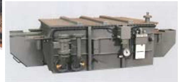
Fahrmotor 1,25 MW / 1790 V / 459 A Loktrafo 5,22 MVA
