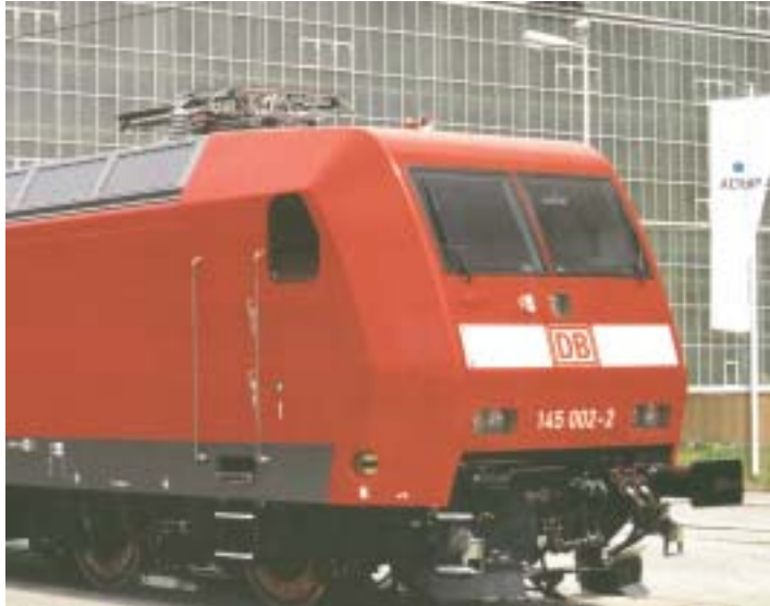
DB-Mehrzweck-Lok BR 145 (ADtranz) Baukastensystem (BR 101/BR 145) (1997 - 2000 ca. 80 Loks) 84 t, 140 km/h, 4.2 MW, F_{za} = 300 \text{ kN}
