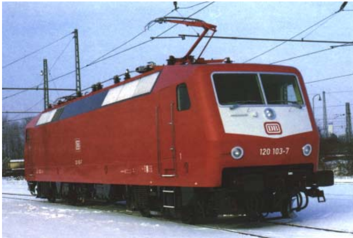
16 2/3 Hz-DAT-Universallokomotive BR 120 für die DB (ABB, Siemens, AEG) – 1987, ab 1993 mit GTO-UR mit nur 17 Halbleiterventilen, 50% Volumen, 155% Leistung gegenüber der Thyristorausführung ab 1983 (5,6 MW, 290 kNm, 200 km/h)
