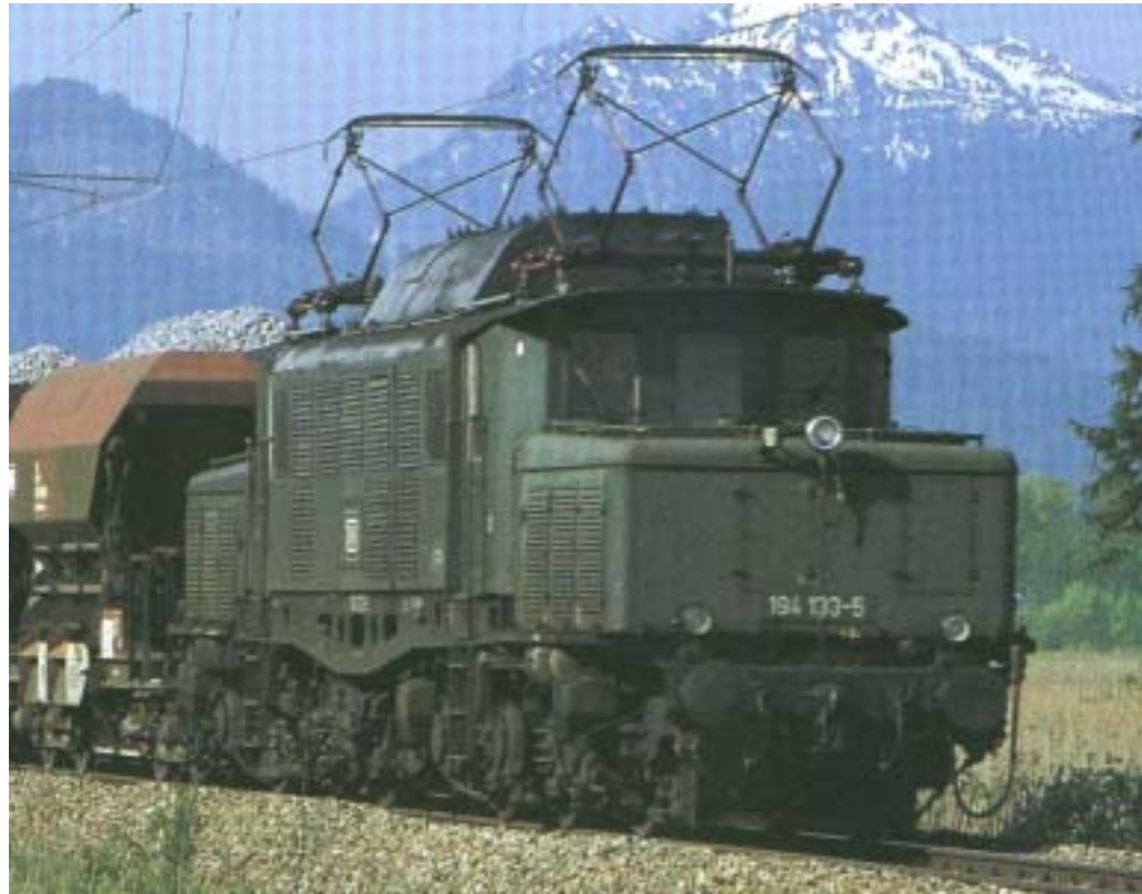
BR 194 - sechssachige Einheitslok für schwere Güterzüge (AEG u.a.) Bj. ab 1940: 145 Lok an die DRG, 3,1 MW, 90 km/h, 363 kN, mit el. Bremse; nach 1945 bei DB, DR und ÖBB im Einsatz
