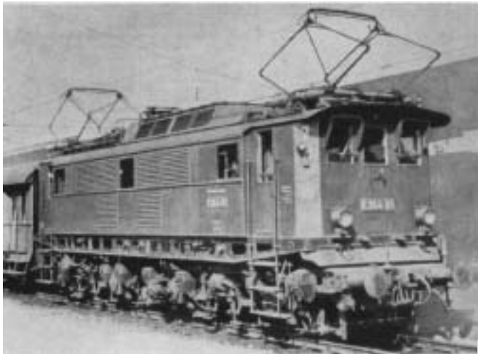
Versuchslok 244 01 der Höllentalbahn - AEG 1932, Ab 1936 im Regelbetrieb Gleichrichterlok mit gittergesteuertem Hg-GR (18 Anoden), torsionssteifer Tatzlagerantrieb
