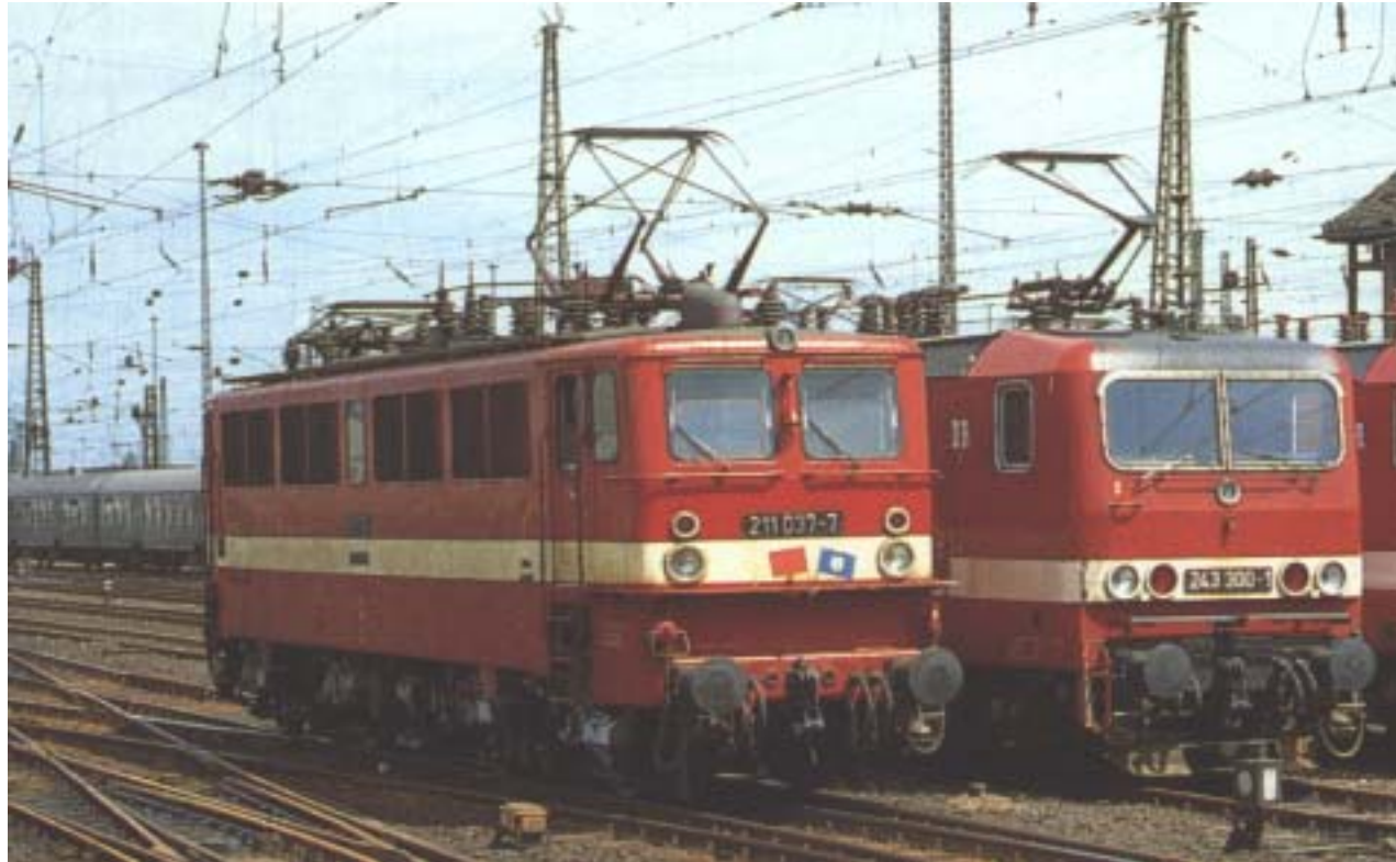
16 2/3 Hz-Schnellzuglok BR ex211 (NS-Schaltwerk) und Universallok BR ex 243 (NS-Schaltwerk und LE-Feinsteller (LEW - DR) ab 1963 bzw. 1984
