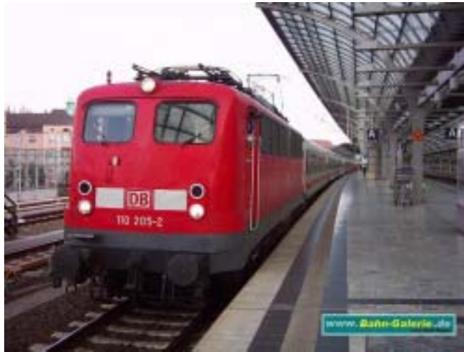
BR 110 Klassische WS-Ellok der DB 1957-63 Krauss-Maffei + Krupp + AEG + SSW + BBC (3,7 MW, 140 km/h, 84,6 t)
