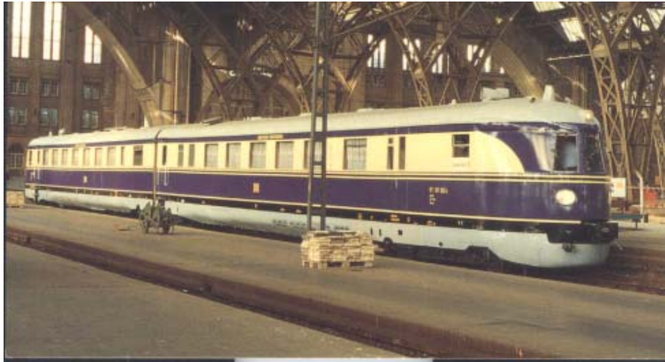
Dieselektrischer Triebzug (SVT 137), Bauart Hamburg 1935 (WUMAG Görlitz + SSW) - als Museumstriebwagen in Leipzig 1993
