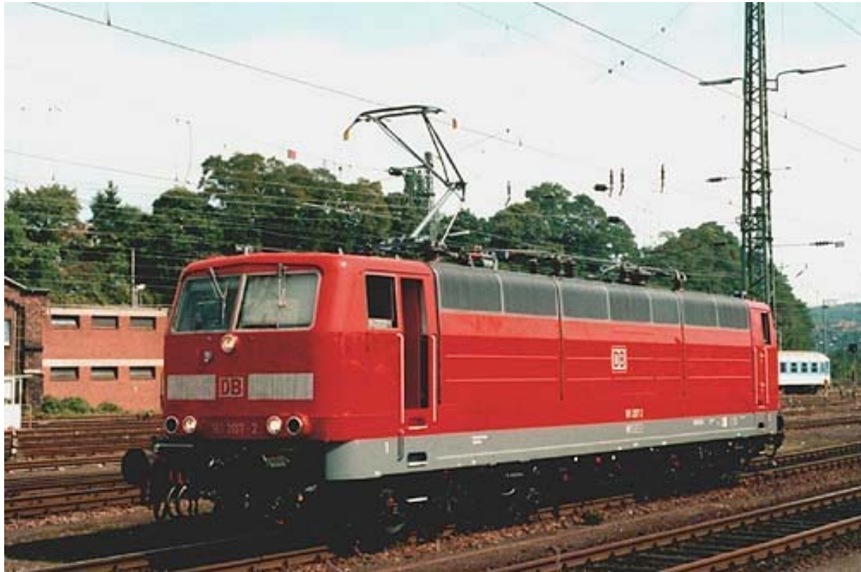
Zweissystem-Ellok BR 181 (16 2/3 Hz + 50 Hz) Universallokomotive für die DB (ABB, Siemens, AEG) – 1987
