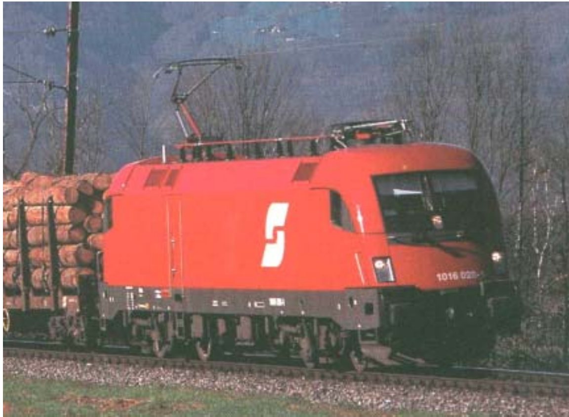
BR 182 DB/1016 ÖBB (Europrinter) Siemens (2001) – Zweisystem-GTO-Lok 16,7 Hz + 50 Hz, 6.4 MW, 86 t, 230 km/h, 300 kN
