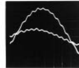
Zeitfunktionen des 4QS mit Störstromfilter
