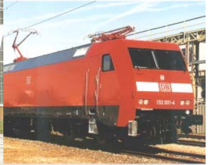
DB-Universal-Elokk-Lok BR 152 (Siemens) Weiterentwicklung Europrintertyp (1997 - 2001 ca. 195 Loks) 86 t, 140 km/h, 6.4 MW, F_{za} = 300 \text{ kN}
