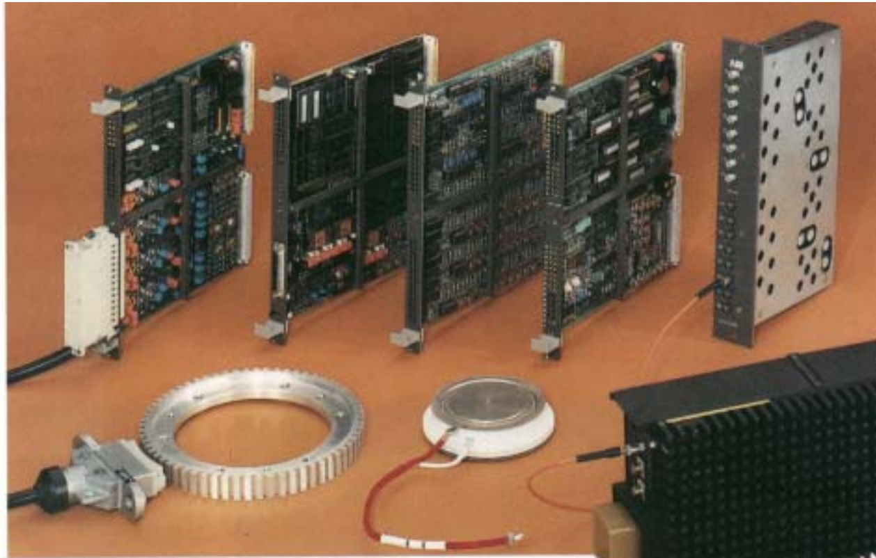
Bestandteile der Leistungs- und Informationselektronik BR 120 (Signalverarbeitungskarten, Drehzahlgeber, GTO-Scheibenzelle, optische Ansteuerung) – Quelle: ABB 1991
