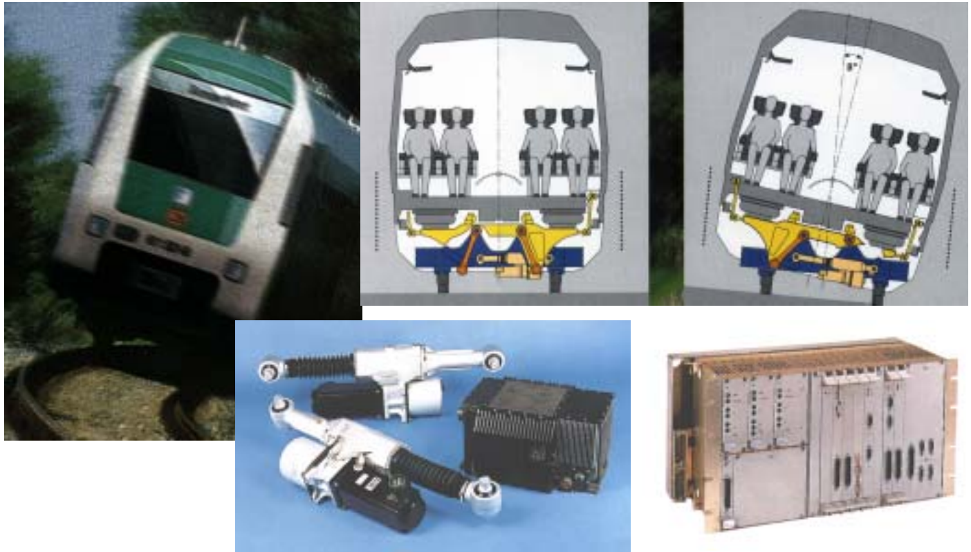
Neicontrol-E ® elektrische Neigetechnik für den zweiteiligen Diesel-Triebzug (2'B'+B' 2') BR 611 der DB AG ab 1996, 116 t, 2 x 0.54 MW, 160 km/h
