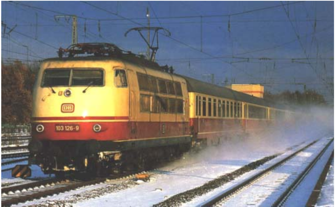
16 2/3 Hz-WS-Hochleistungs-Ellok BR 103 (Siemens) ab 1965 Hochspannungs-Schaltwerk, Thyristor-Feinsteller, 6,2 MW, 200 km/h, 112 t, 6 Achsen
