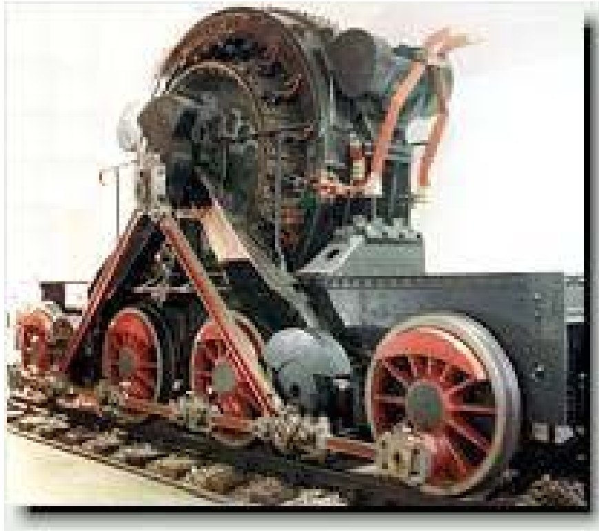
Größter Gestellmotor der Welt für Wechselstromtraktion (15 kV, 16 2/3 Hz) (ausgestellt im Verkehrsmuseum Dresden)
