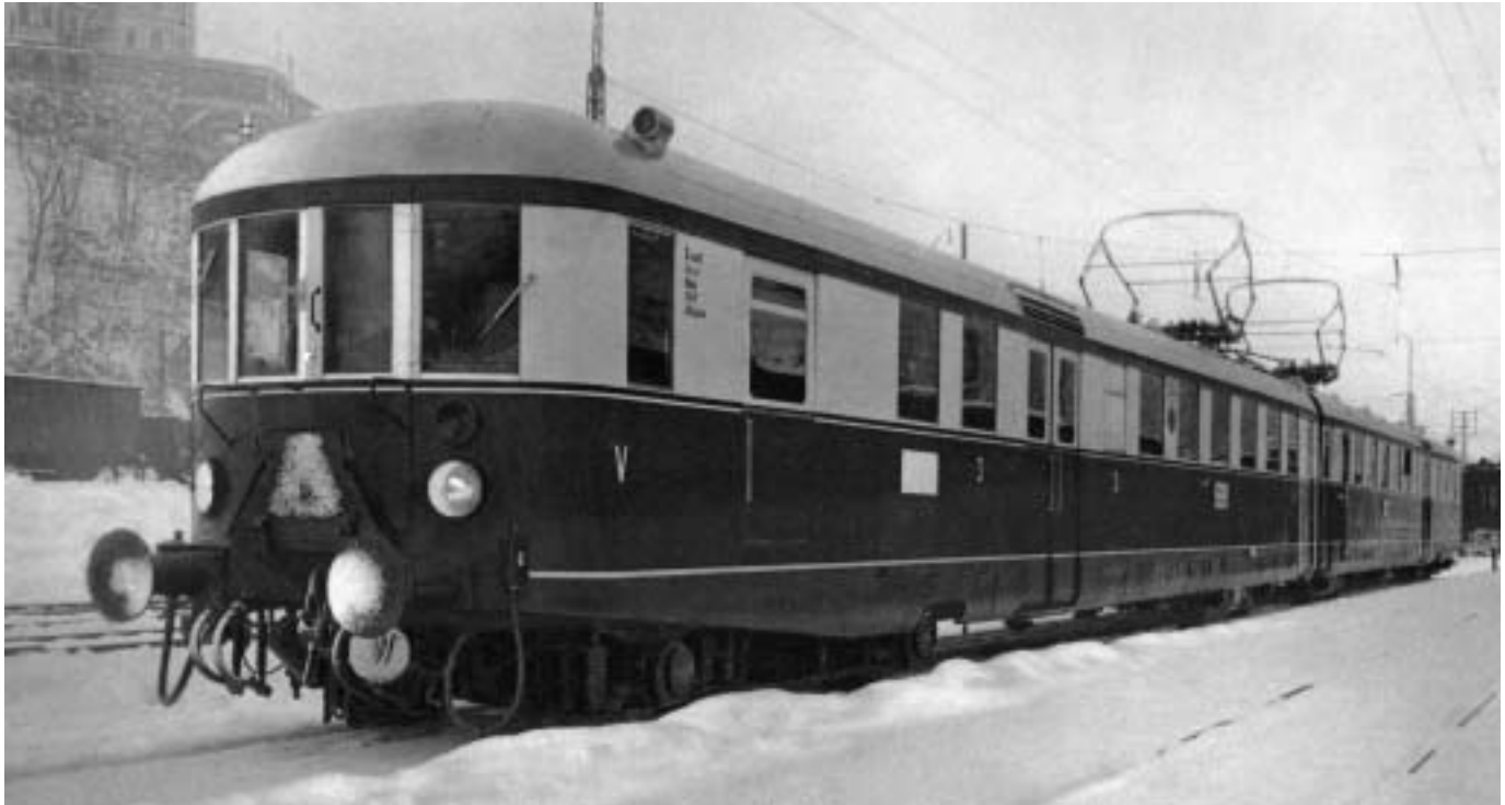
Wechselstrom-Triebwagenzug (15 kV, 16 2/3 Hz) für die Strecke Halle - Leipzig (1935)
