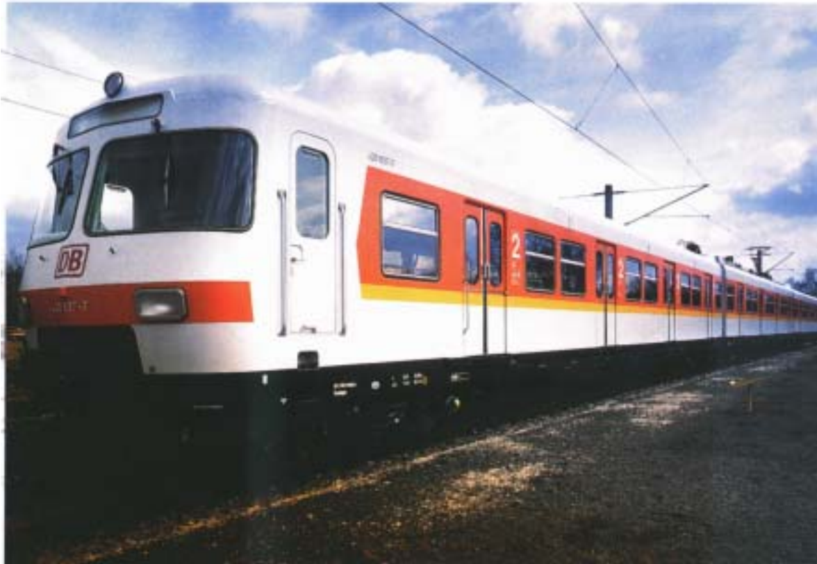
BR 420 Standard-Triebzug für den Nahverkehr der DB (15 kV/16 2/3 Hz) Siemens ab 1972, fast 500 Einheiten gebaut, dreiteilig, 2,4 MW, 120 km/h, 138 t
