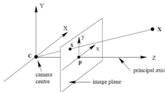
Ein „Vektor“  $h \in \mathbb{R}^3$ , d.h.  $h = [h_1, h_2, h_3]$  beschreibt die Menge der Strahlen im  $\mathbb{R}^3$  mit  $X = \lambda \cdot [h_1/h_3, h_2/h_3, 1]$
