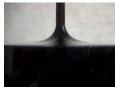
Aufnahme der Verformung der freien Oberfläche [1]. In der Mitte dieser Abbildung ist der stromdurchflossene Leiter zu erkennen.
