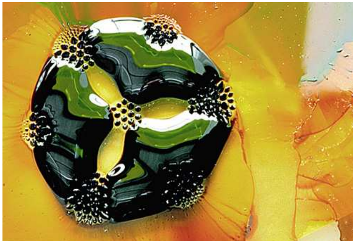
Abbildung 1.1: Ein Tropfen magnetischer Flüssigkeit auf einer Glasplatte mit sieben Dauermagneten. © Felice Frankel, 1997.
