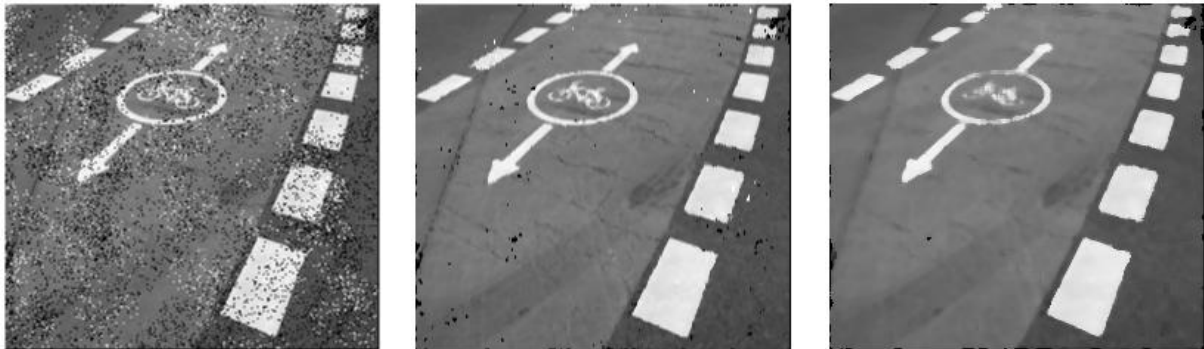
Bild 5-2: Verrauschte Aufnahme einer Fahrspur; Medianfilter mit einer 3x3 und einer 5x5 Nachbarschaftsmatrix; Diese und die nachfolgenden gefilterten Bilder wurden mit Matlab erzeugt.
