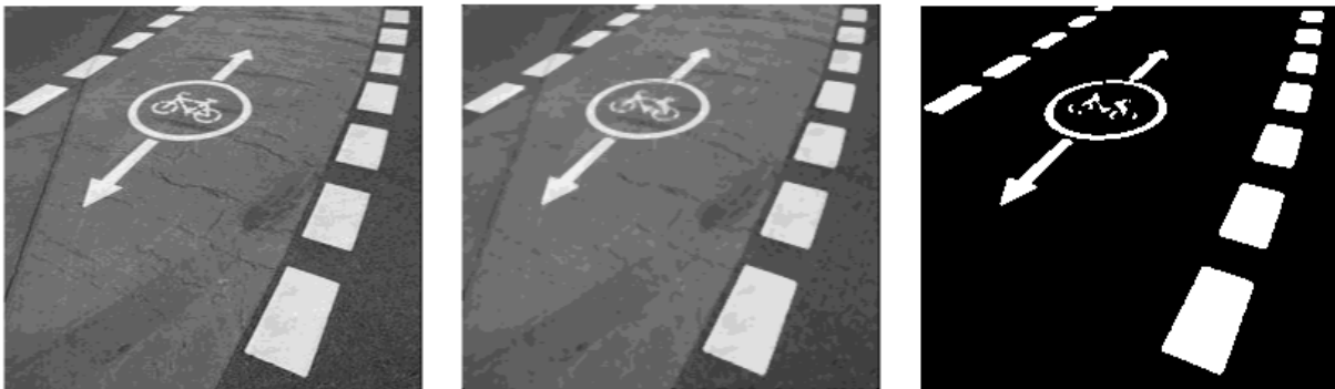
Bild 8-1: Anwendung des Medianfilter und Binarisierung mit einem Schwellwert von 75%
