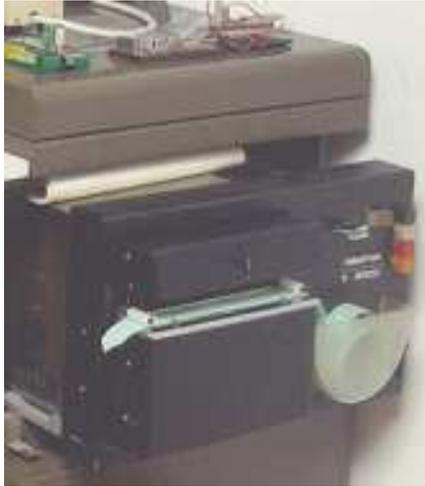
**Lochbandstation als 19“ Einschub K6200 von Robotron Sömmerda etwa ab 1980**
