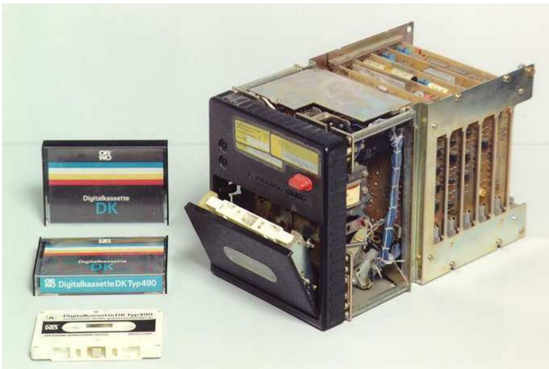
**Digitalkassette etwa ab 1980 in der DDR in Kleinrechnern K1600 (PDP11) und Mikrorechnern mit der CPU U880 (Z80) eingesetzt**
