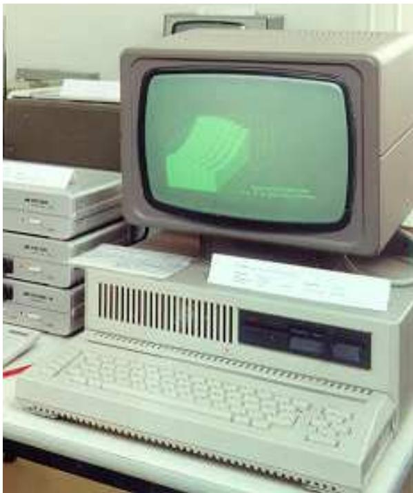
der Bezeichnung KC87 eine verbesserte Variante mit 48K RAM und 16K ROM verkauft. 1988 wurde dann daraus der BIC A5105 für den Einsatz an den Schulen entwickelt. Für eine schnelle Grafik wurde der U82720 und für die Floppy der U8272 eingesetzt. Der BIC konnte vernetzt werden.
