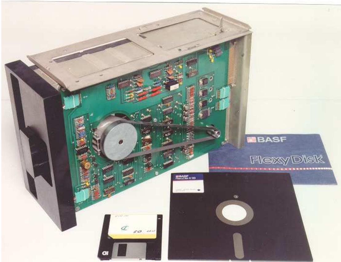
**8" Diskettenlaufwerk mit Diskette ab 1980 in der DDR in einer Reihe von Rechnern mit der CPU U880 (Z80) eingesetzt**
