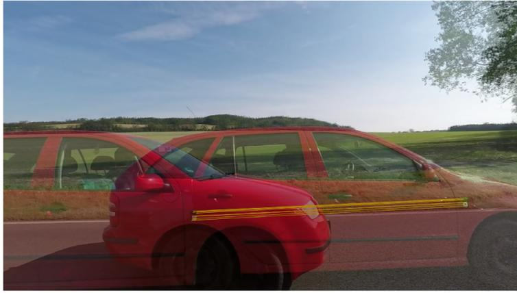
Abbildung 1: Vektoren von Featurezuordnungen nach dem LSM zwischen erstem und letztem Bild einer Bildsequenz
