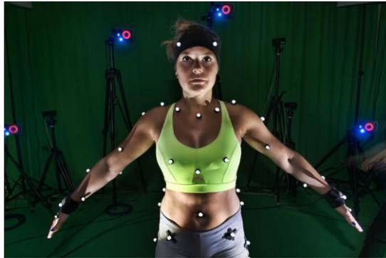
Abb. 1 markerbasiertes Motion Capturing
